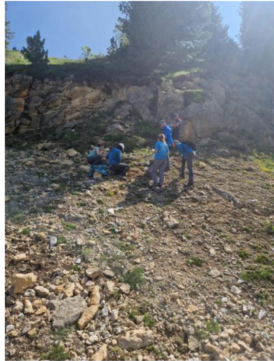
Figure 13 : Photographie du talus choisi pour expérimenter des techniques de génie végétal dans un objectif de stabilisation, avec une pente de 32^{\circ} , s'étendant sur 100\text{m}^2 .
